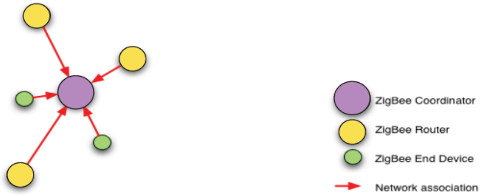
Figura 1.15 Tipos de dispositivos Zigbee
