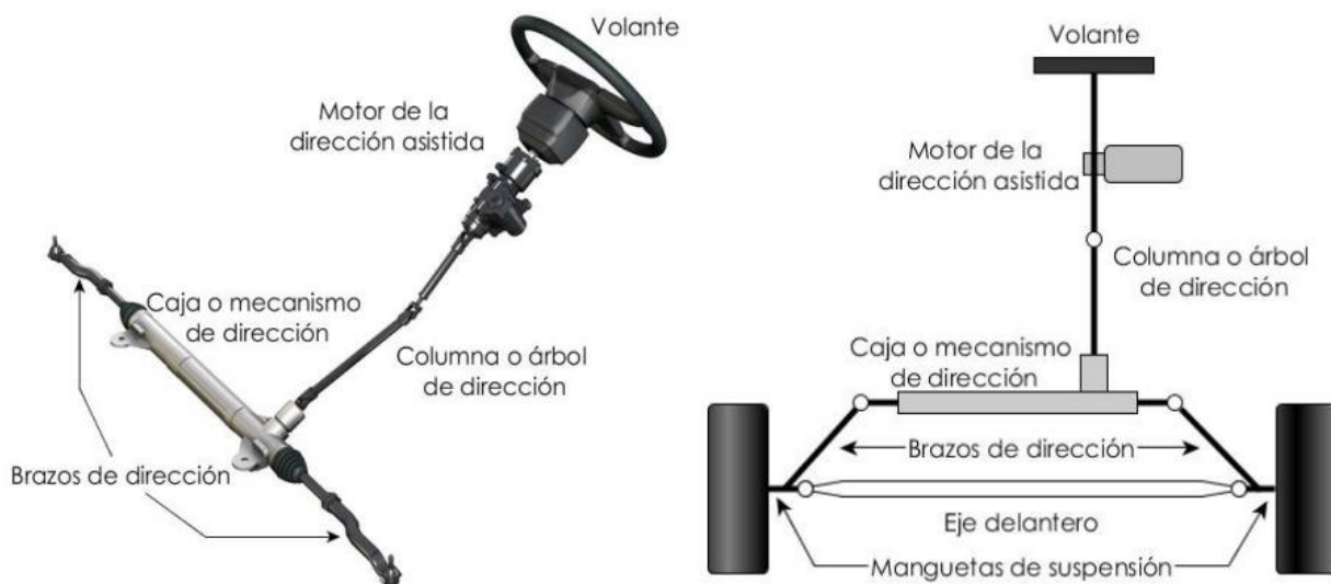
Figura 3.5: Identificación de los componentes del sistema de dirección del vehículo
