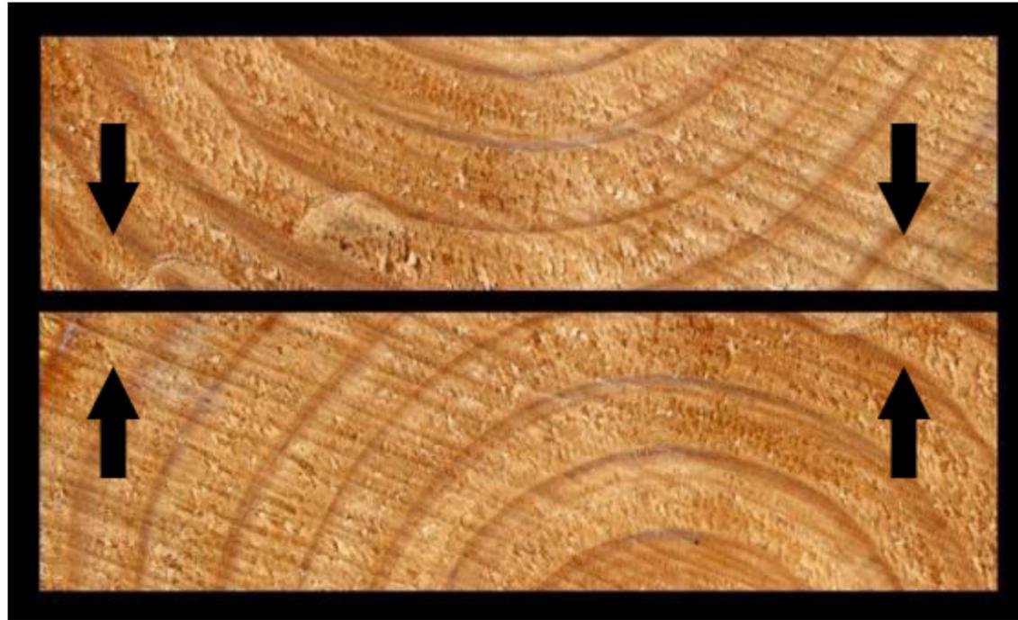
Fig 17. Colocación de tablas para correcta unión. Las flechas muestran el movimiento que harán los anillos.
