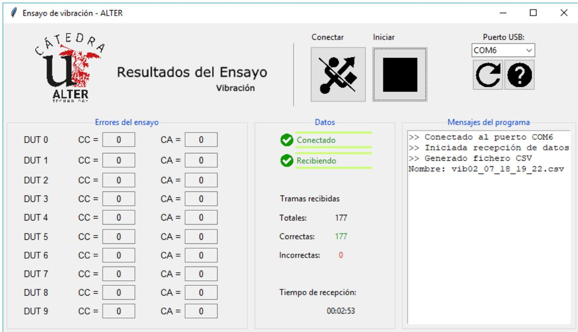
Figura 6-2. Captura del software durante la prueba de transmisión
