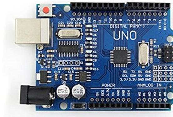
Figura 5-12. Microcontrolador Arduino UNO
