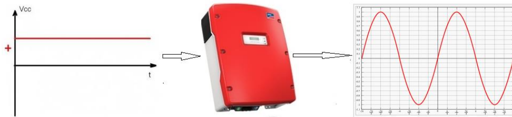
Figure 1-10. Representación funcionamiento del inversor. Fuente propia
