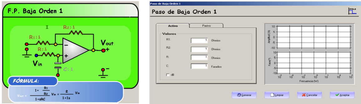
Figura 6: Filtro paso de baja de orden 1: Esquema, función de transferencia y captura de especificaciones.
