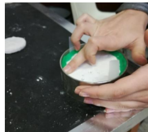
[FIGURA13] PROBETA EN EL TUBO DE KUNDT
