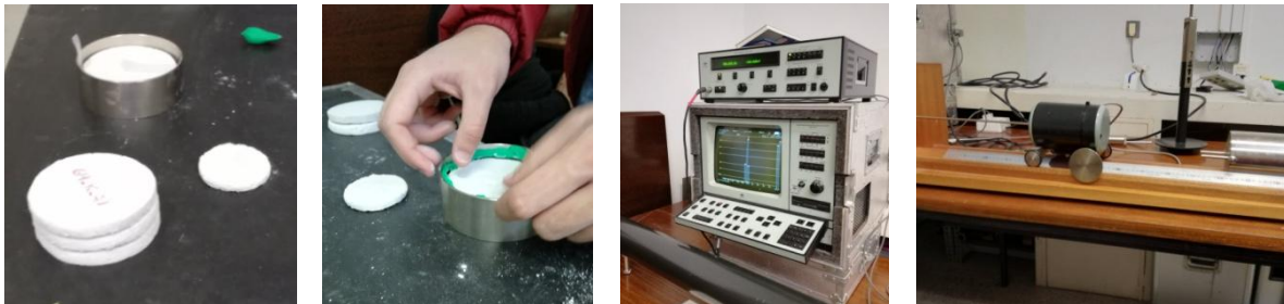
[FIGURA 37] DIFERENTES MUESTRAS ANTES DEL ENSAYO DE ABSORCIÓN ACÚSTICA (fuente: propia).
