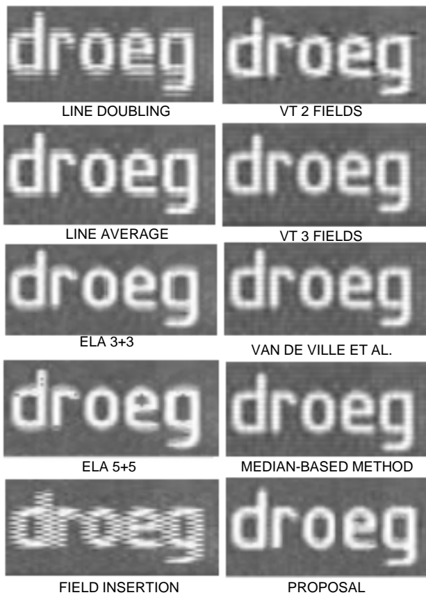
Fig. 4. Fotograma desentrelazado con distintos métodos de la secuencia híbrida TMF.
