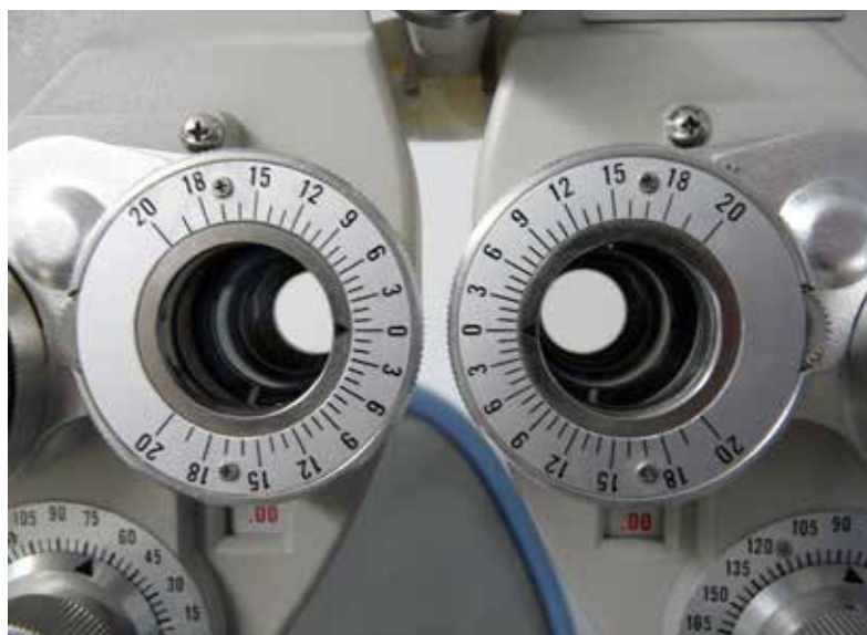
Figura 13. Prismas de Risley en la posición “0” a 180° para la medida del rango de vergencias fusionales verticales. Fuente: elaboración propia.
