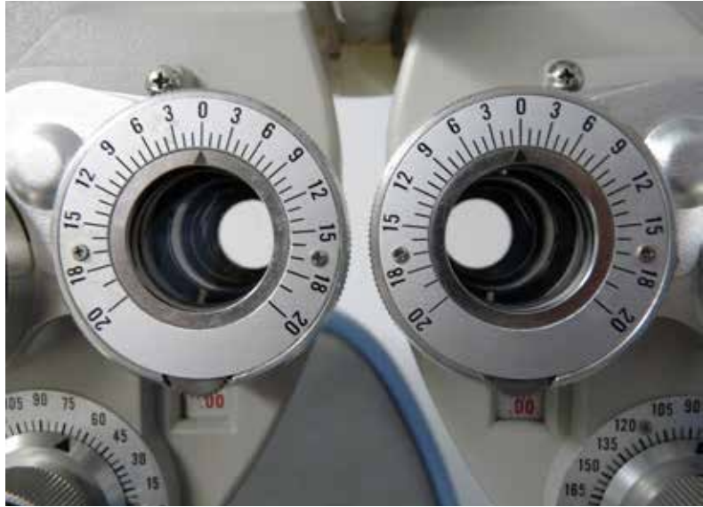
Figura 12. Prismas de Risley en la posición “0” a 90° para la medida del rango de vergencias fusionales horizontales. Fuente: elaboración propia.
