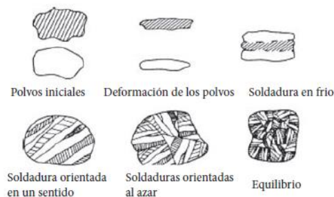
Figura 6. Esquema de la morfología de los polvos durante el proceso [1].
