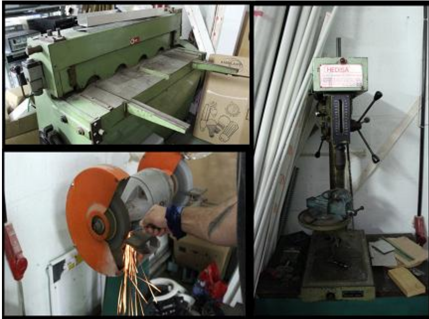
Collage 4: Distintas herramientas empleadas en el mecanizado de la MARC. Arriba a la izquierda la cortador. A la derecha la perforadora vertical. Abajo a la izquierda la pulidora.
