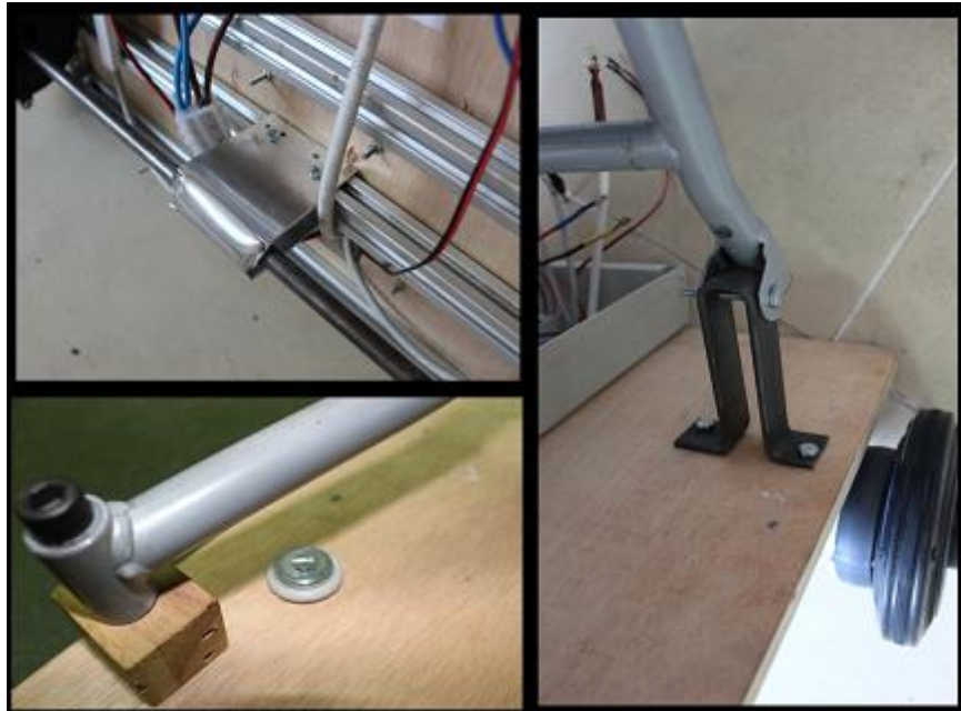
Collage 5: Piezas obtenidas mediante el mecanizado. Arriba a la izquierda, la pletina que sujeta el eje de las ruedas e impide que se doble. Abajo a la izquierda, tanto el taco de madera como el tornillo que sujeta las ruedas locas delanteras pero sobretodo este último han sido procesados mecánicamente. A la derecha la pieza de sujeción de la silla a la plataforma.
