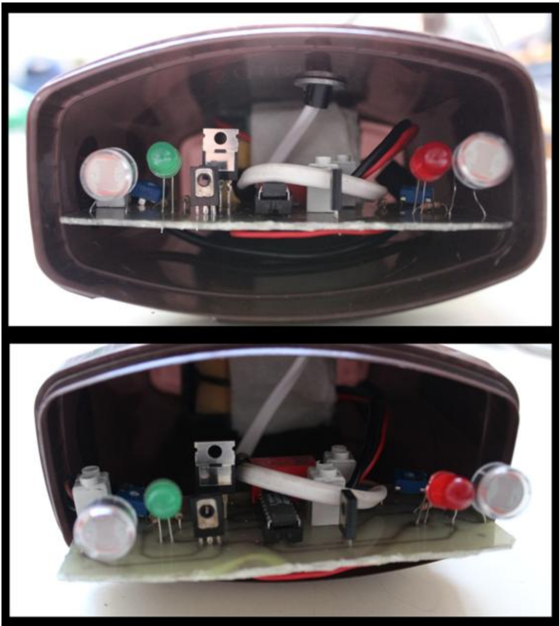
Collage 6: Interior del Interruptor Diana del Licornio Láser. Se pueden observar las dos zonas fotosensibles asociadas a los LEDs Rojo y Verde.
