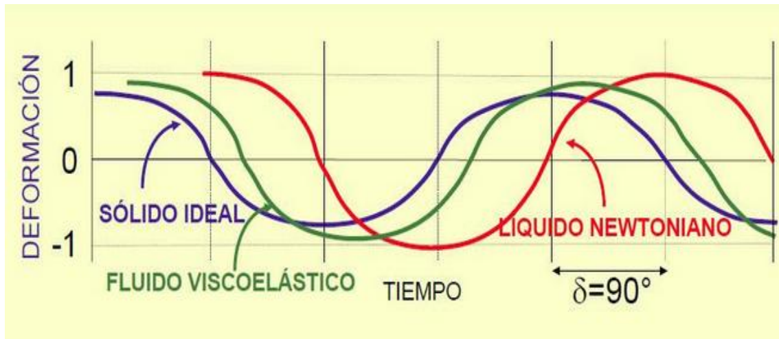
Figura 9. Ensayos dinámicos para un sólido ideal, fluido newtoniano y fluido viscoelástico
