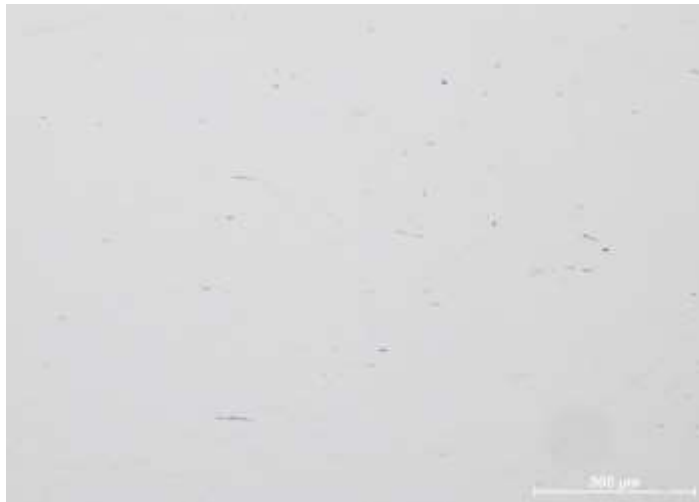
Figura 10. Muestra sin atacar donde se observa las inclusiones de la pieza.
