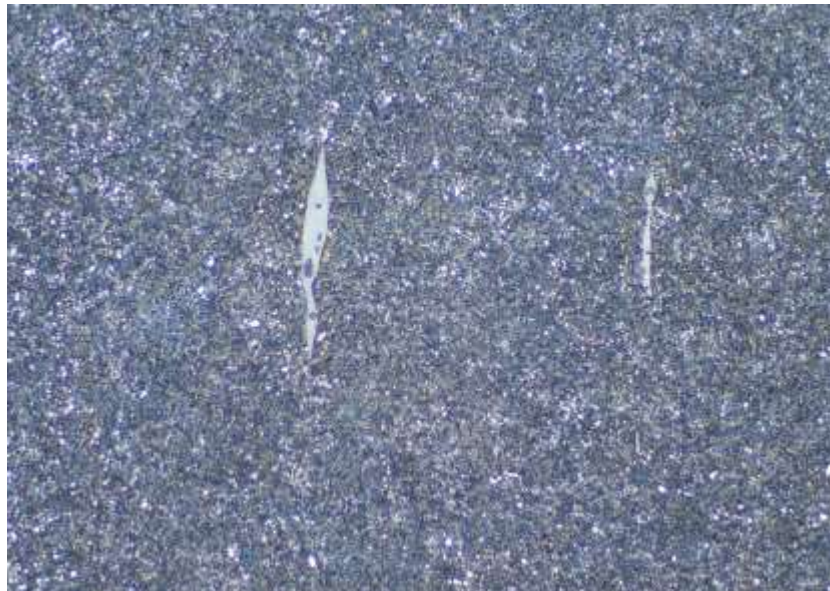
Figura 9. Inclusiones en la estructura.
