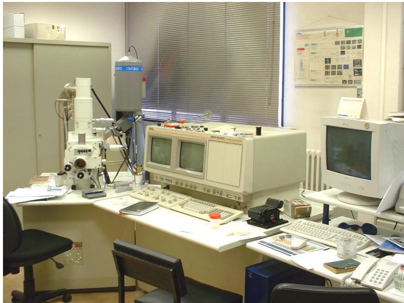
Figura 1. Microscopio electrónico de barrido SEM modelo JSM-6400 Scanning Microscopy.
