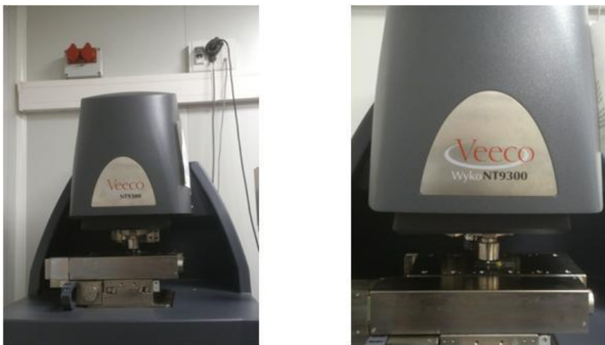
Figura 2. Interferómetro de luz blanca ( Optical Profiling System ).
