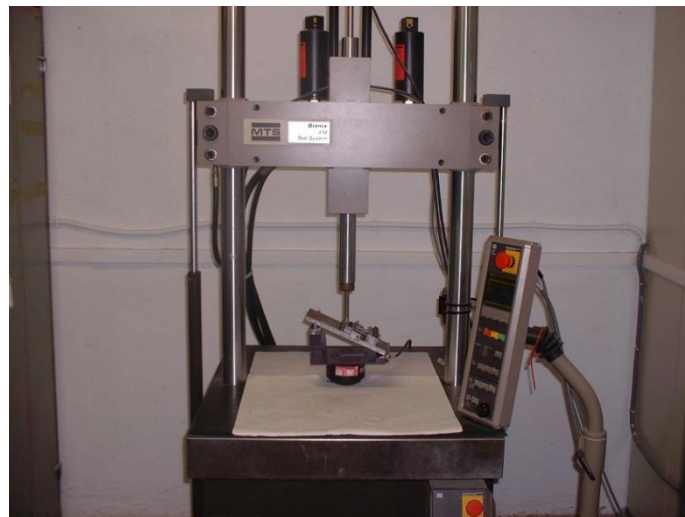
Figura 4. Máquina de ensayos de tracción-compresión MTS Bionix 858
