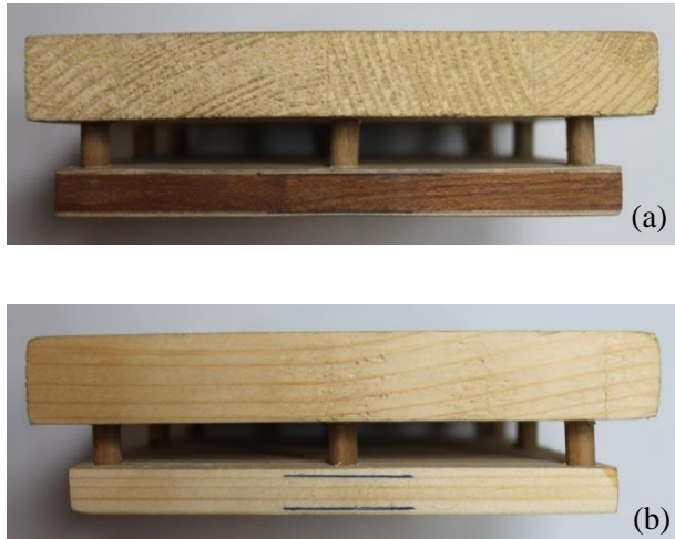
Figura 4. Modelos terminados. (a) Losa aligerada. (b) Losa maciza.
