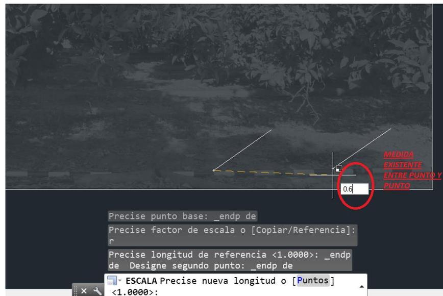
Figura 50: Captura de pantalla de la precisión de la medida conocida en el proceso de escalar la imagen.
