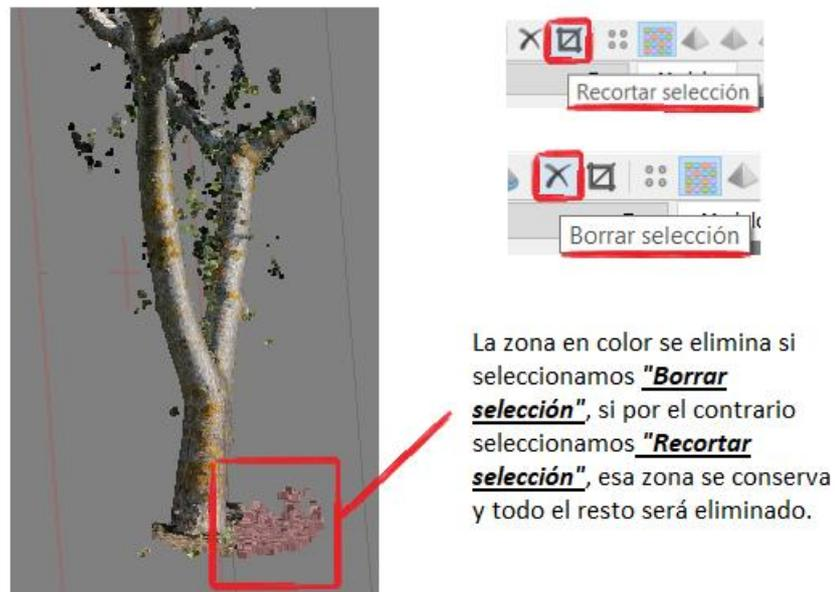
Figura 39: Captura de imagen de borrado y cortado de la nube de puntos densa; modelo en edición (Izquierda) y opciones de borrado (derecha).
