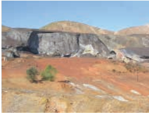
Figura 4. Escombreras de materiales estériles procedentes de la explotación Cerro Colorado, Minas de Riotinto.
