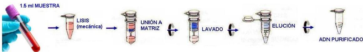
**Figura 2.- Pasos de la extracción manual, desde la lisis mecánica de la muestra hasta la purificación del ADN**
