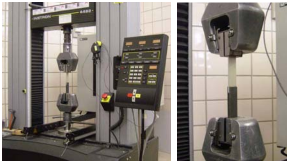
Figura 11. Ensayos sobre las uniones adhesivas.
