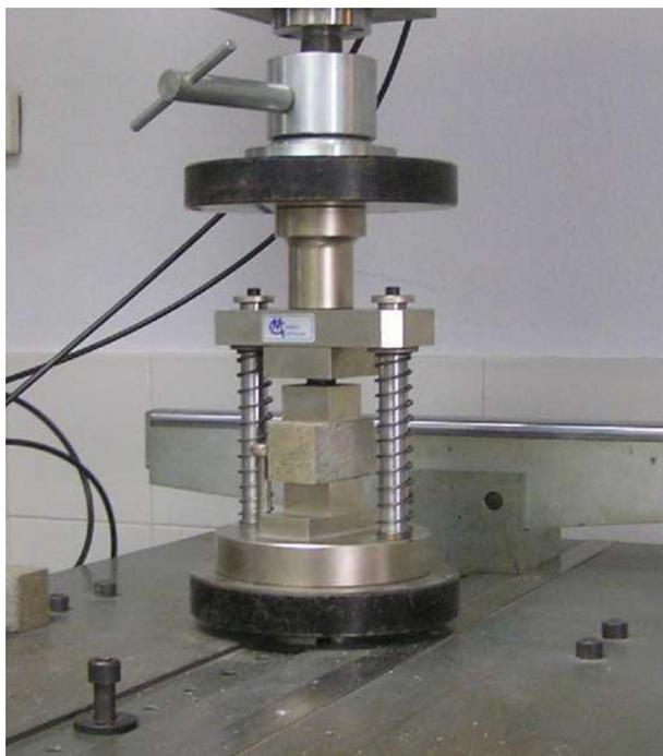
**Figura 4 – Dispositivo de ensayo a compresión.**
