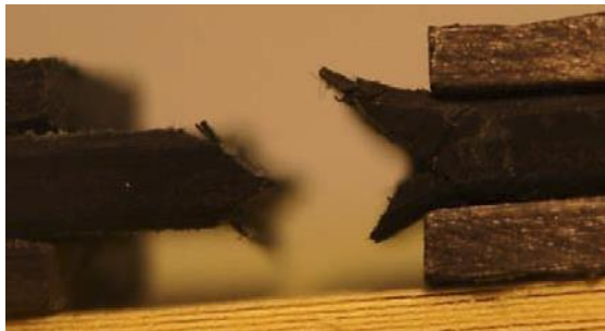
Figura 6. Vista micromecánica del fallo entre fibras ante compresión transversal.
