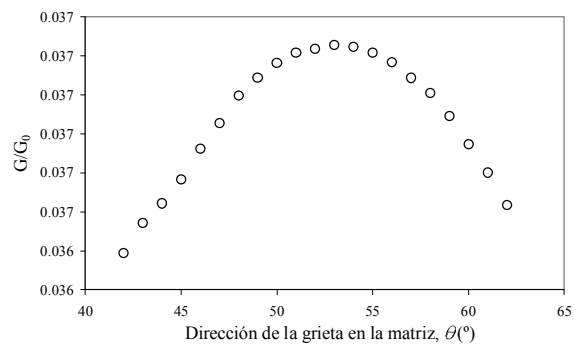
Figura 17. Visión aumentada de la evolución de G de la grieta incipiente en la matriz para distintas orientaciones de la misma.
