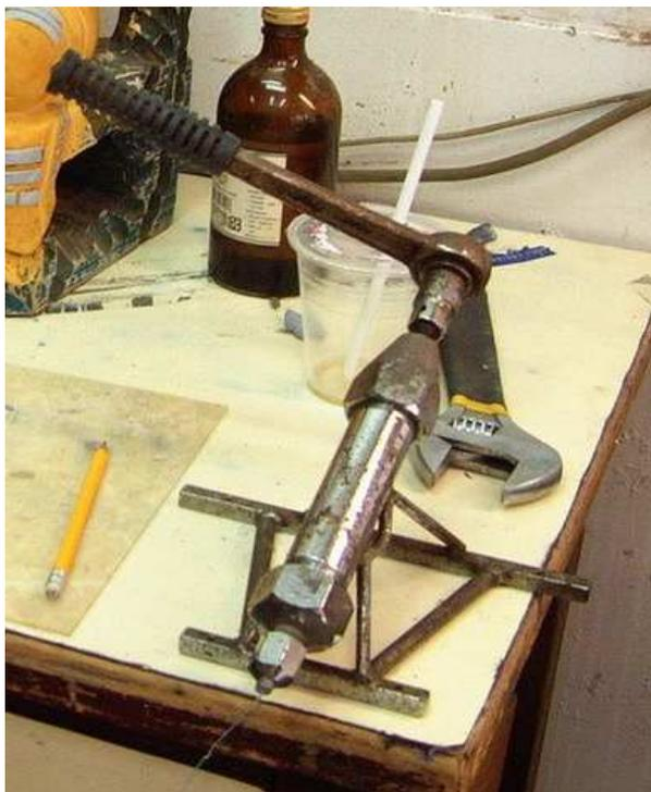
Fig.141. Aparato mecánico para la pasta de hilo de laca
