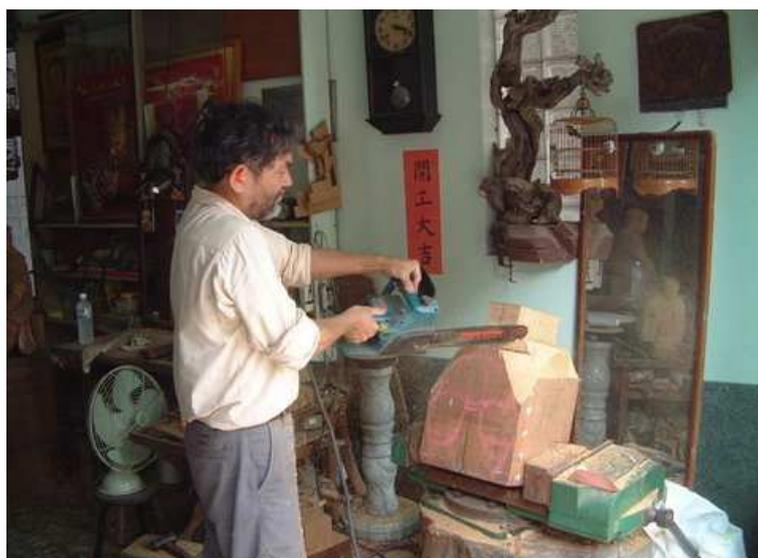
Fig.115.116. Quitando las partes que sobran con la sierra eléctrica
