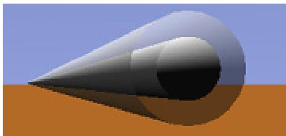
Ilustración 49-Tubo absorbedor y cubierta de vidrio
