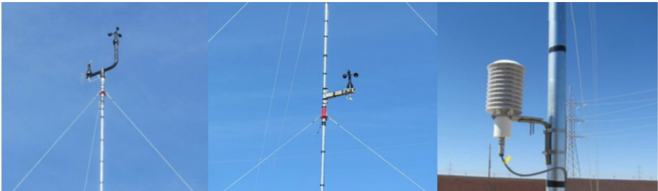
Figura 13. Equipos de medición adicionales: dirección, velocidad del viento y temperatura. © CENMA.
