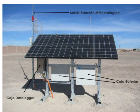
Figura 10. Alimentación y comunicación de la estación. © CENMA.
