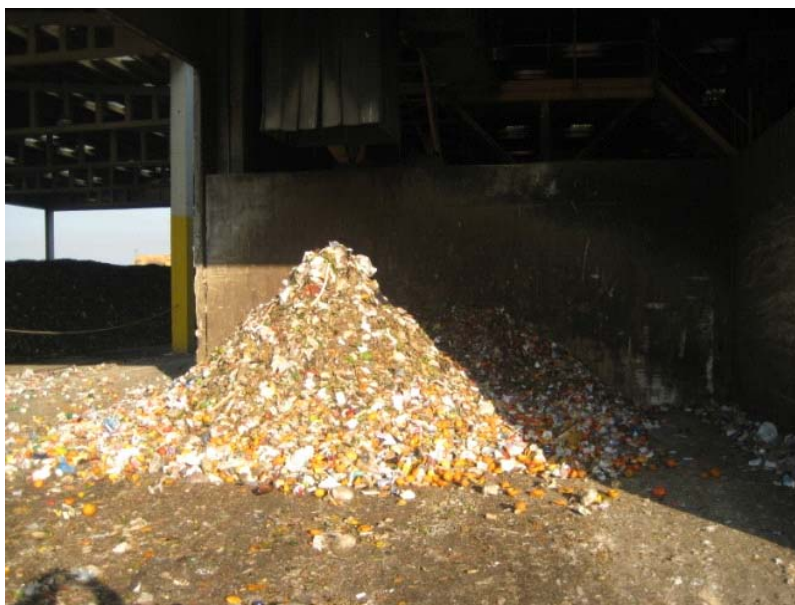
Foto 6.4: Trituración de la materia orgánica a ser compostada
