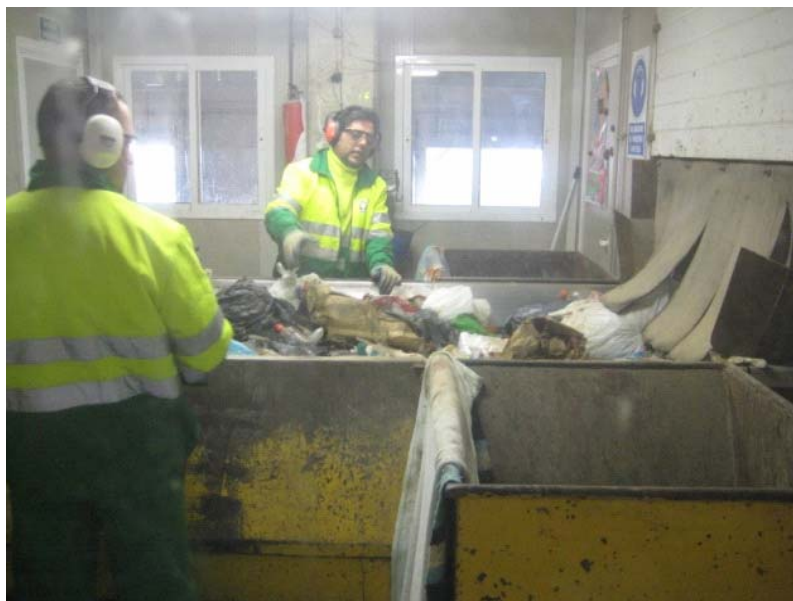
Foto 6.3: Clasificación manual de residuos.
