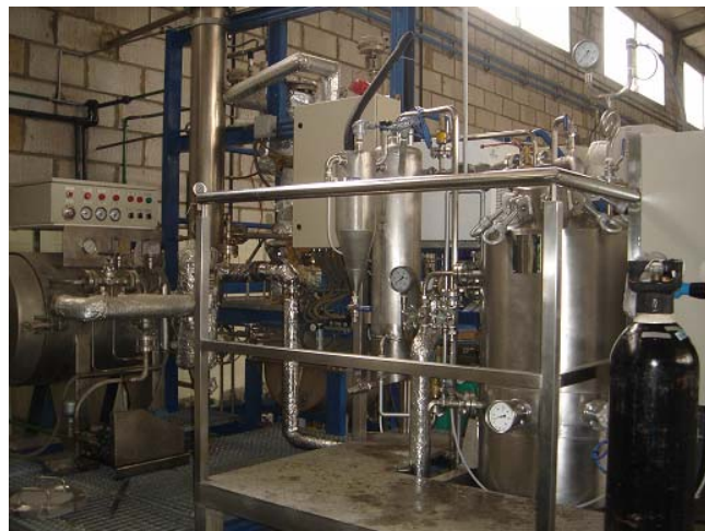
Figura 5 a y b: Esquema (a) y fotografía (b) del nuevo reactor del tratamiento con vapor utilizado y diseñado en el Departamento de Fitoquímica de los Alimentos del Instituto de la Grasa (C.S.I.C.), Sevilla, empleado en el presente trabajo de investigación.
