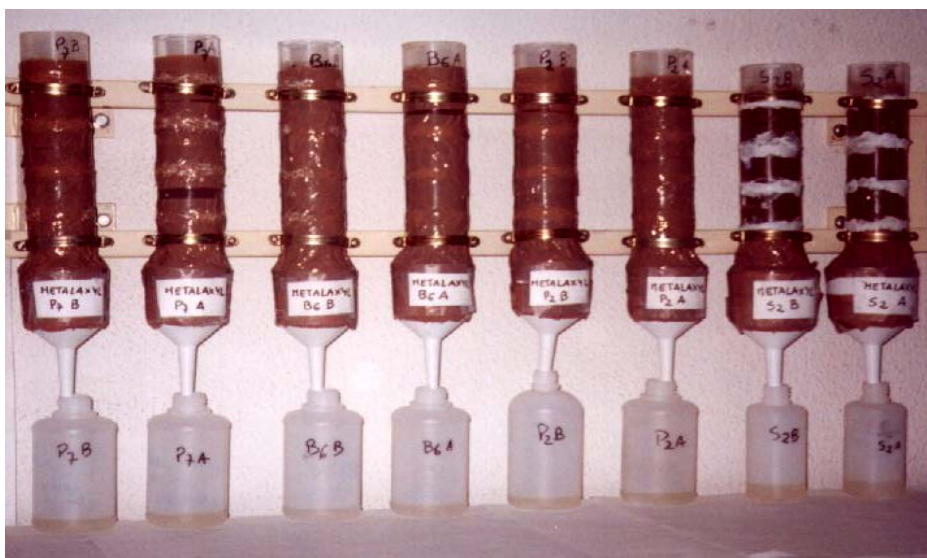
Figura II.2.1. Fotografía de las columnas empaquetadas de suelo de metacrilato durante el estudio de la movilidad de plaguicidas en suelos naturales.
