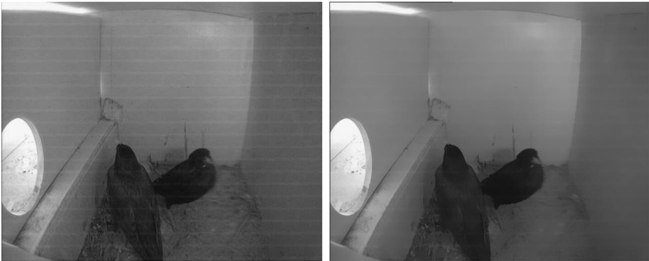
Figura 2.23 . Imagen con ruido y resultado tras aplicarle `bilateralFilter( src, dst, 31, 20, 10 )`
