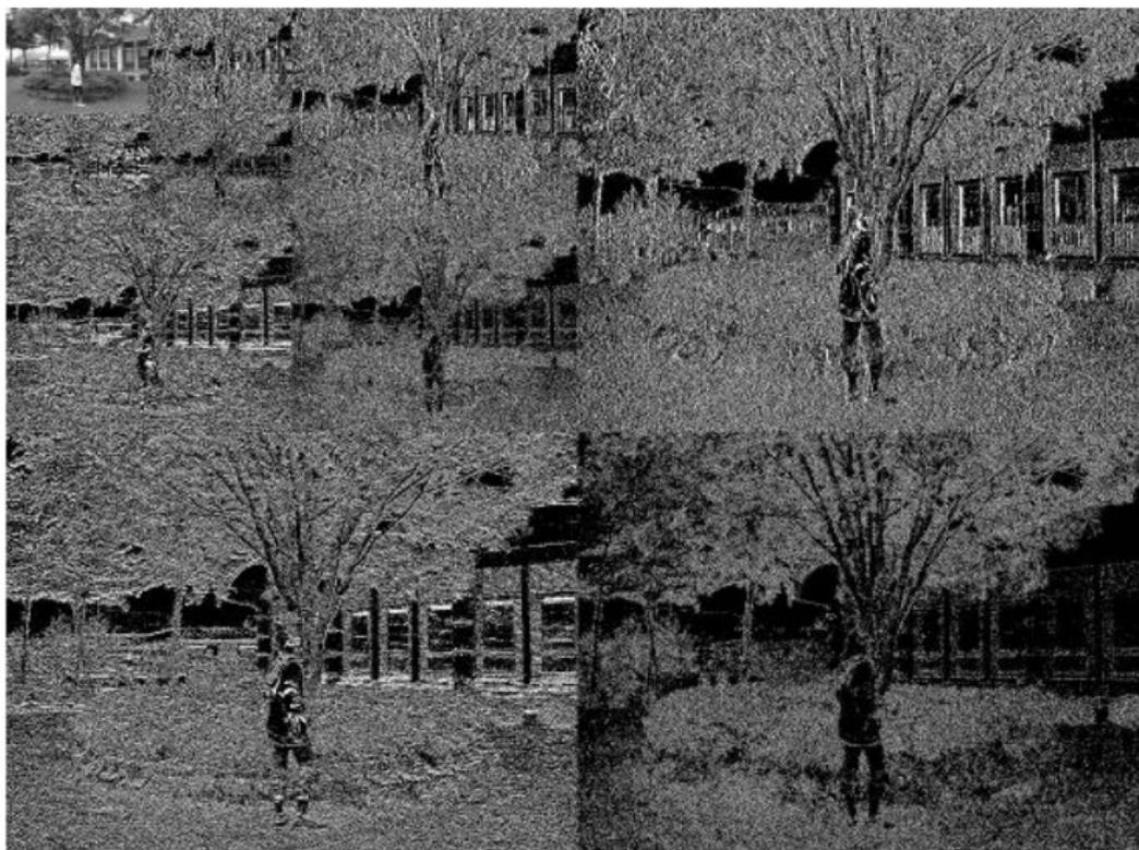
Figura 2.27. Transformada Haar de 3 niveles de una imagen nítida
