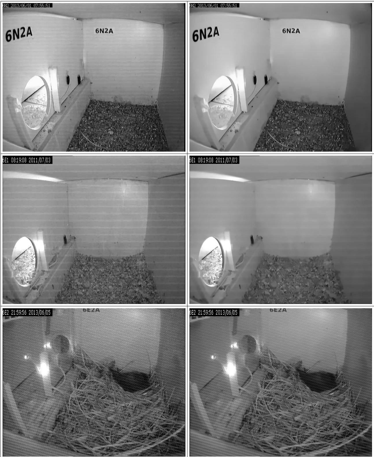
Figura 2.24. A la izquierda tres imágenes distintas afectadas con ruido, a la derecha el resultado de aplicar el filtro `fastNlMeansDenoising` con `h=3`, `templateWindowSize=7` y `searchWindowSize=21`.
