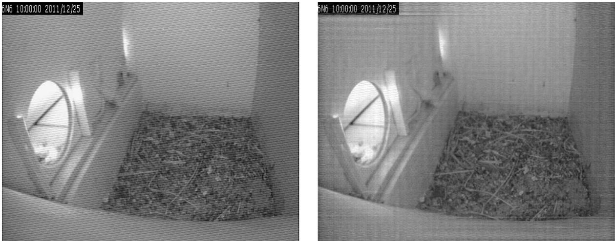
Figura 2.22. Resultado de filtrar una imagen con mucho ruido periódico.
