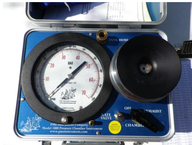
Figura 10. Cámara de presión.
