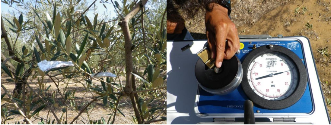
Figura 11. Izquierda: Hoja envuelta en papel de aluminio Derecha: Medida del potencial hídrico.
