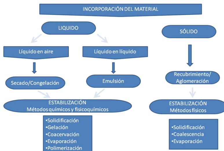
Figura 2. Clasificación de los métodos y técnicas de microencapsulación en función del estado del material a encapsular
