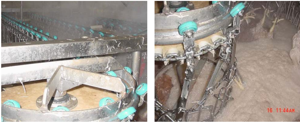
Figura 18. Tanques de escaldado
