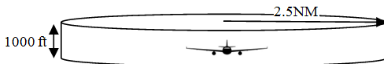
Figura 2-2. Cilindro de protección
