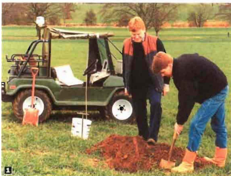
Foto 1. Toma de muestras de suelo en puntos georreferenciados por GPS.
