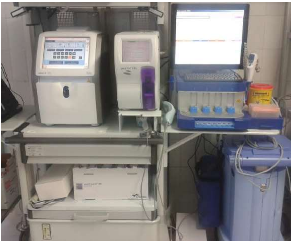
Figura 24: Módulo completo POCT, formado por (de derecha a izquierda) : dispositivo ROTEM®, analizador hematológico pocH-100i y gasómetro Cobas b 123.
