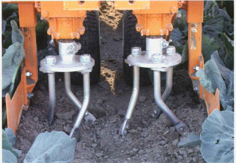
Foto 2. Rotocultor de eje vertical con túnel de protección del cultivo (Struik Wieringermeer BV).
