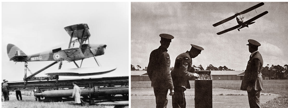
Figura 1.1 Lanzamiento de un DeHavillan Queen Bee en 1941 (izquierda) y panel de control remoto del mismo (derecha). Fuente: Wikipedia.
