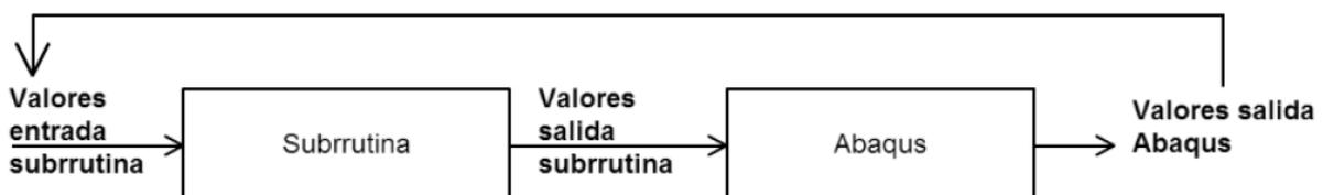
Figura 5.1: Funcionamiento de una subrutina con Abaqus como programa principal
