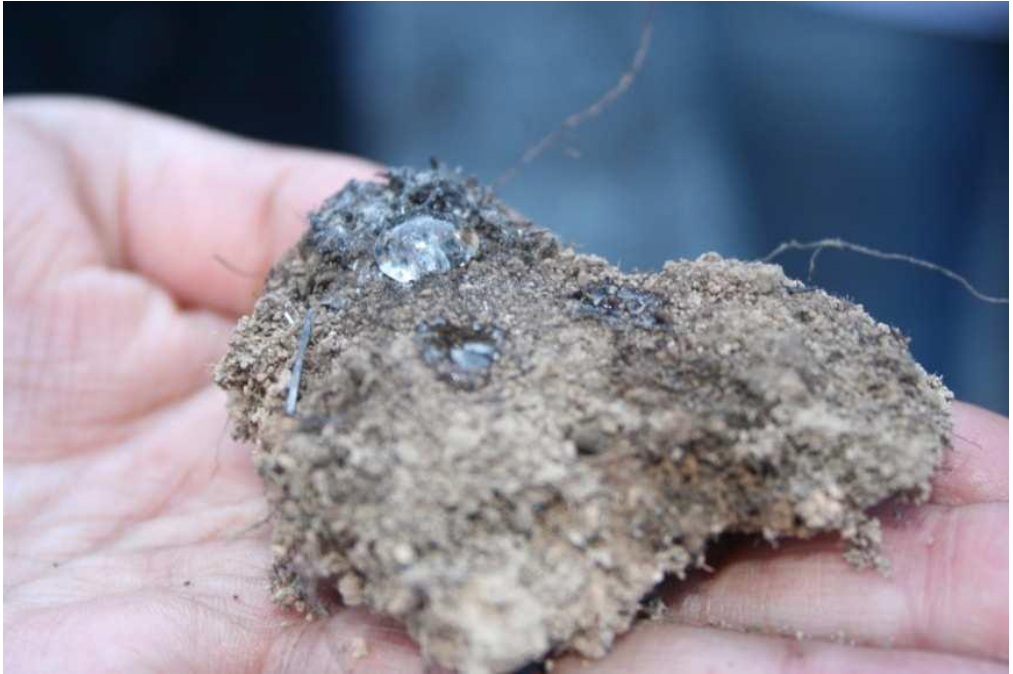
Figura 1. Gotas de agua sobre la superficie de un agregado repelente al agua tras un incendio forestal en Gorga (Alicante, 2011). Fotografía: Lorena M. Zavala.
