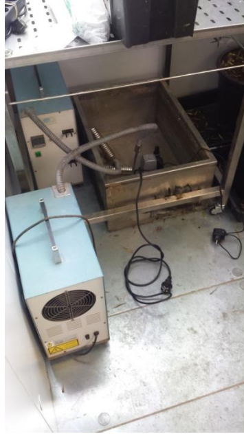
Imagen 8. Detalle del sistema empleado para enfriar el suelo. Bañera con el líquido anticongelante y dos enfriadores.
