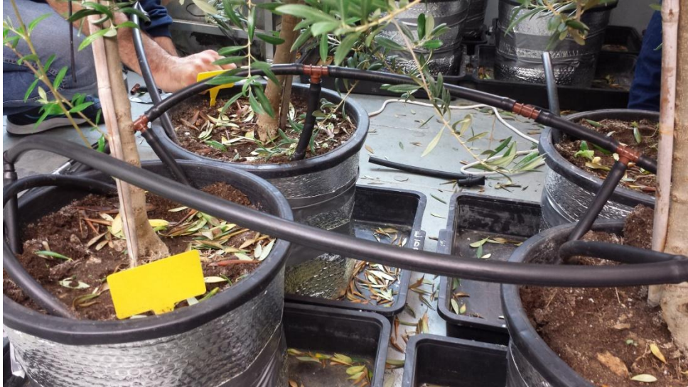
Imagen 6. Sistema de tubería empleado para el transporte del anticongelante.
