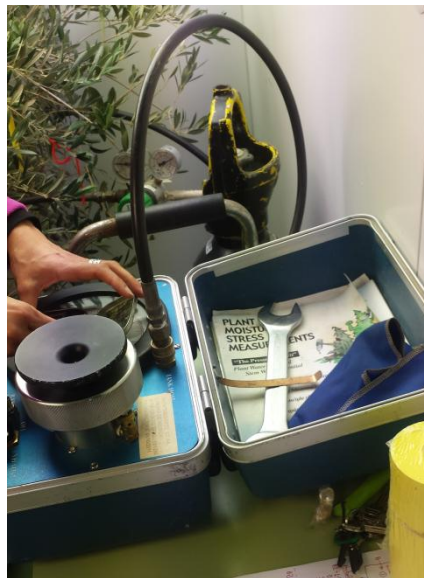
Imagen 10. Cámara de Scholander usada para medir el potencial.
