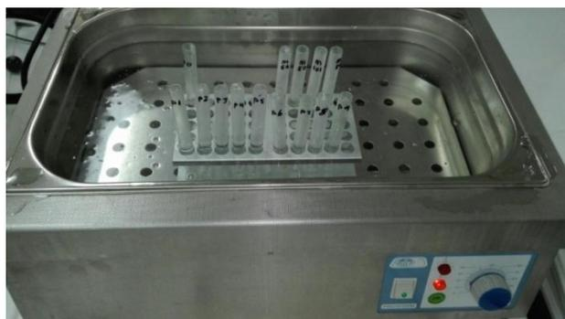
**Figura 18.** Baño de agua caliente, gradilla de acero inoxidable y tubos de ensayo.
