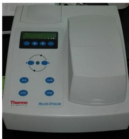
**Figura 19.** Espectrofotómetro para la medida de la absorbancia.
