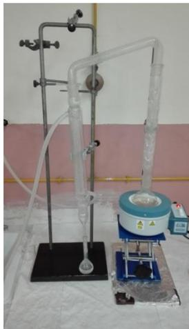
**Figura 17:** Sistema de destilación automática por arrastre de vapor compuesto por columna de rectificación, elevador de laboratorio de 150 x 15, tubo refrigerante, adaptador de destilación, adaptador recto, matraz de destilación de fondo redondo de 250 ml y manta calefactora FIBROMAN-C.
