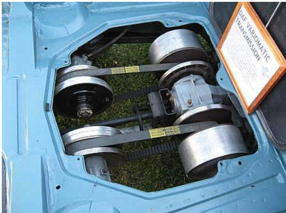
**Figura 4.8 – Transmisión *Variomatic* de DAF.**
