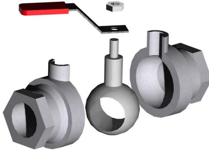
**Figura 2.3.** Válvula de bola despiezada
