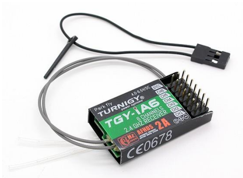
Ilustración 2-10. Receptor de señal de radio Turnigy TGY-IA6
