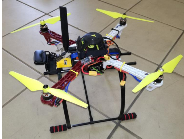
Ilustración 2-1. Erle Copter, montaje completo
