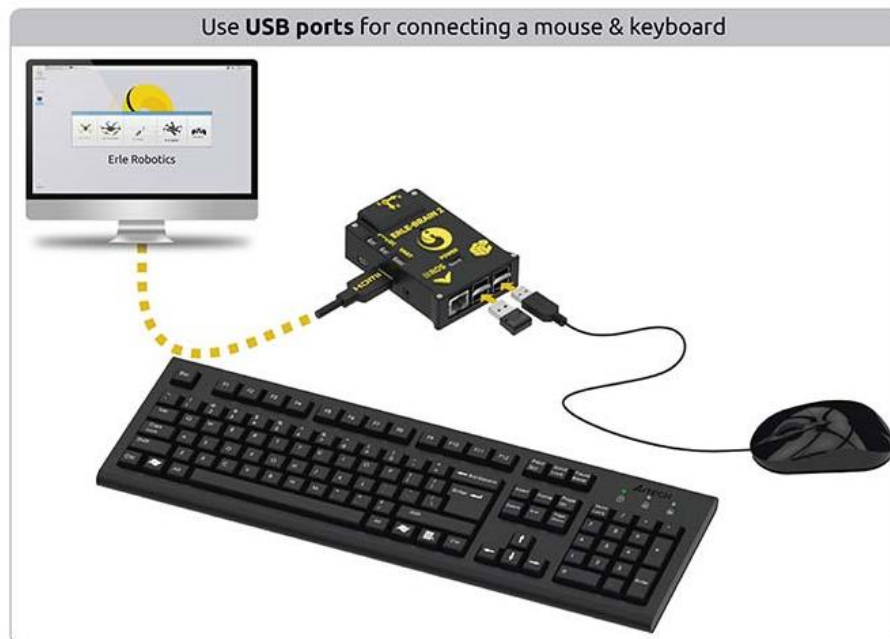
Ilustración 4-4. Conexiones de Erle-Brain 2 a periféricos
