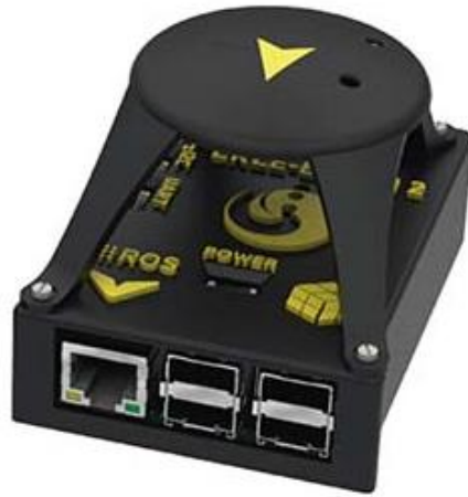
Ilustración 2-13. Encapsulado GPS-Erle Brain 2
