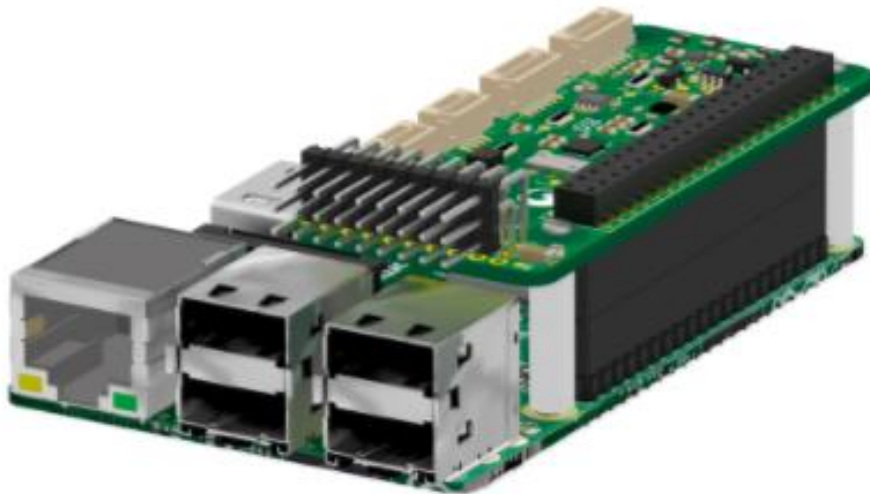
Ilustración 2-18. Unión de la placa PXFmini a Raspberry Pi 2
