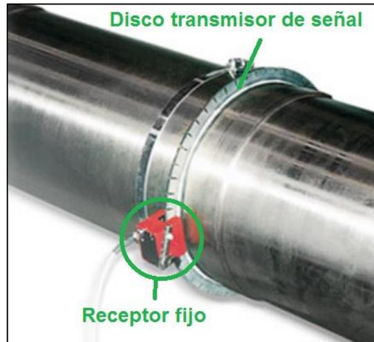
Figura 2-14 Transductor por telemetría de tipo disco
