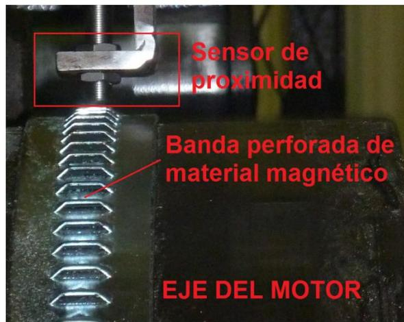
Figura 2-4 Montaje del sistema de medición de la velocidad instantánea
