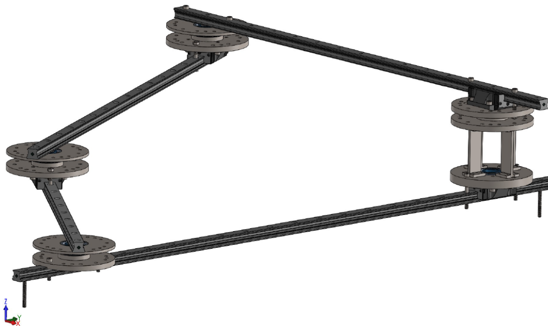
Ilustración 3-0.1: Imagen global del mecanismo, configuración cuatro barras.
