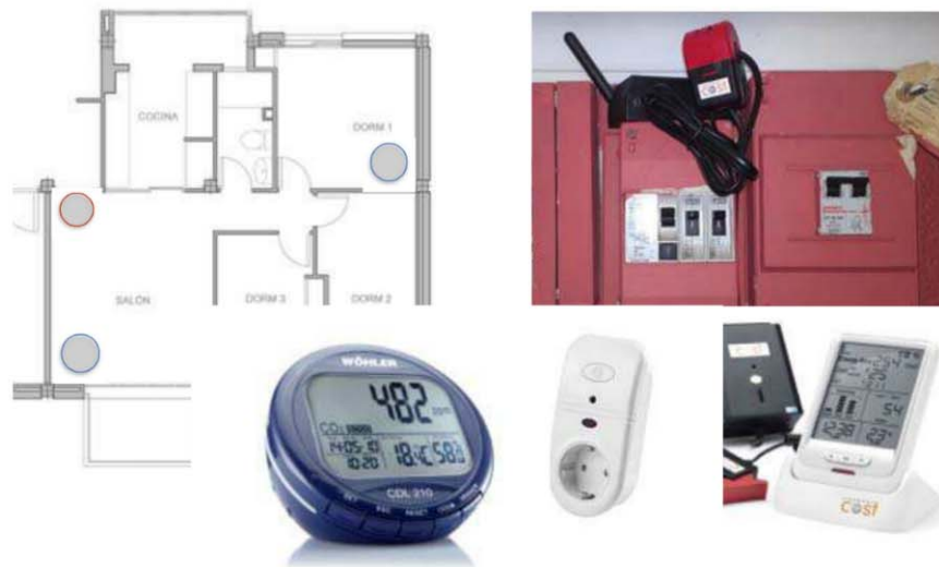
Fig. 2 Equipos de monitorización de variables ambientales y energéticas
