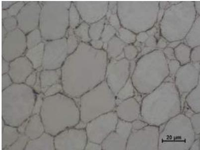
**Figura 14:** MO imagen TMCs+B<sub>4</sub>C vía HP
