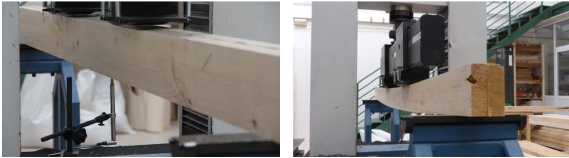
Fig. 6 Duo beams test according to UNE EN-408.
