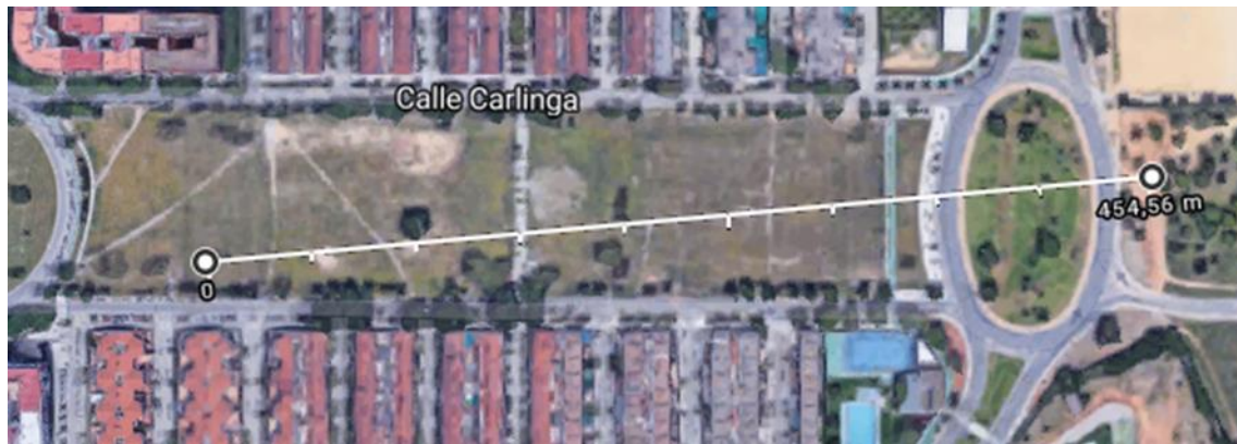
Ilustración 14. Distancia máxima probada con las nuevas antenas.
