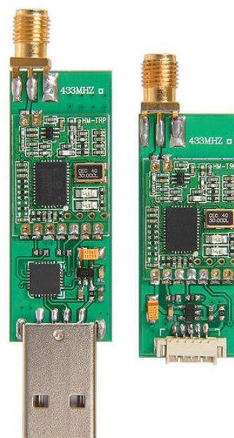
Ilustración 7. Módulos de telemetría.
