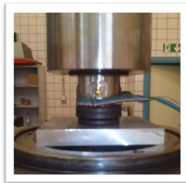
Figura 13. Disposición del anillo en la calibración
