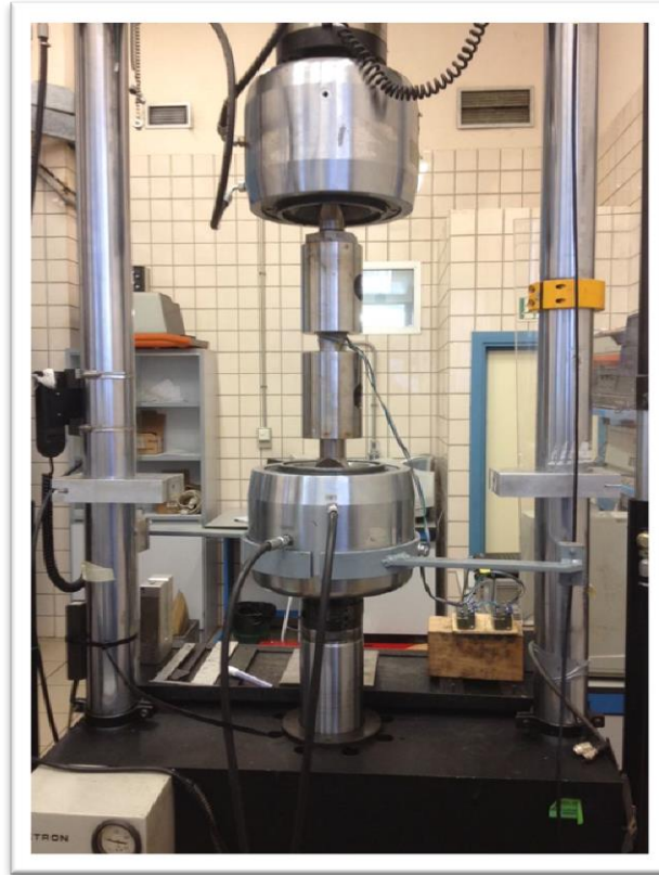
Figura 27. Conjunto montado en Instron 8833
