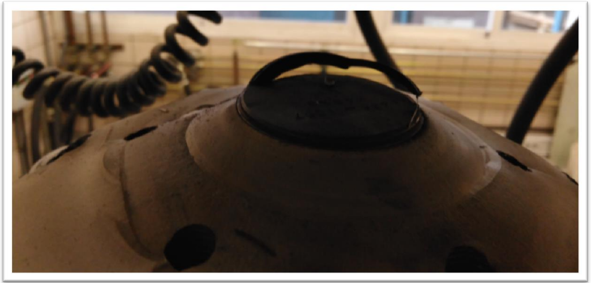
Figura 40. Célula de carga rota por fatiga 2
