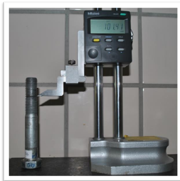
Figura 21. Altura filete crítico
